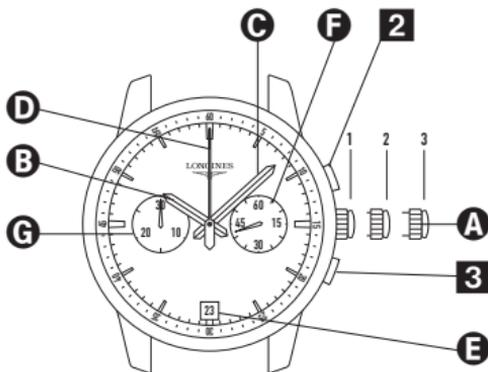
**A** Coroa**B** Ponteiro das horas**C** Ponteiro dos minutos**D** Ponteiro dos segundos do cronógrafo**E** Janela da data**F** Segundos pequenos**G** Contador de 30 minutos**2** Botão arranque/paragem.
