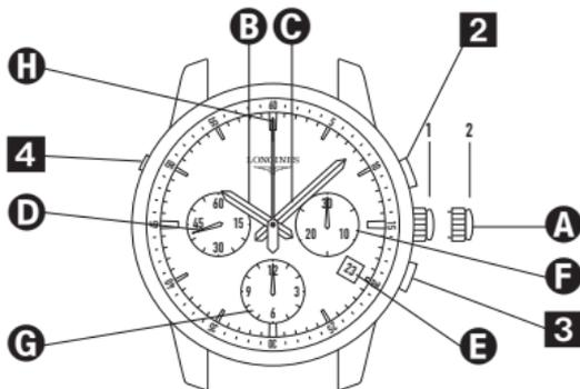
**A** Krone**B** Stundenzeiger**C** Minutenzeiger**D** Kleine Sekunde**E** Datumsfenster**F** 30-Minutenzähler**G** 12-Stundenzähler**H** Sekundenzeiger des Chronographen**2** Drücker zum Starten/ Stoppen. Auslösen und Stoppen des Chronographenzeigers und der Zähler**3** Drücker zur Nullrückstellung des Chronographenzeigers und der Zähler**4** Korrektor für das Datum
