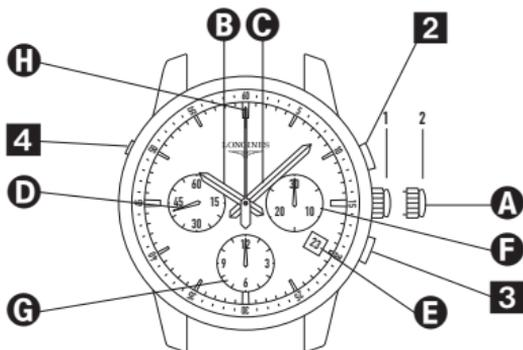
**A** Krone**B** Stundenzeiger**C** Minutenzeiger**D** Kleine Sekunde**E** Datumsfenster**F** 30-Minutenzähler**G** 12-Stundenzähler**H** Sekundenzeiger des Chronographen**2** Drücker zum Starten/
