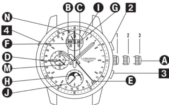
**A** 錶冠**B** 時針**C** 分針**D** 小秒針**E** 日曆指針**F** 星期視窗**G** 月份視窗**H** 月相顯示**I** 30分鐘計時盤**J** 12小時計時盤**M** 24小時AM/PM顯示**N** 計時秒針**2** 開始/停止按鈕。啟動和關閉計時指針和計時盤**3** 計時指針和計時盤歸零按鈕**4** 星期調校按鈕
